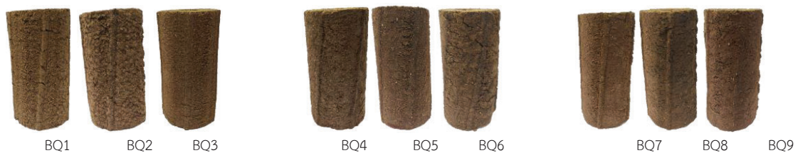
ภาพที่ 2 เชื้อเพลิงชีวมวลอัดแท่งที่ผลิตได้
