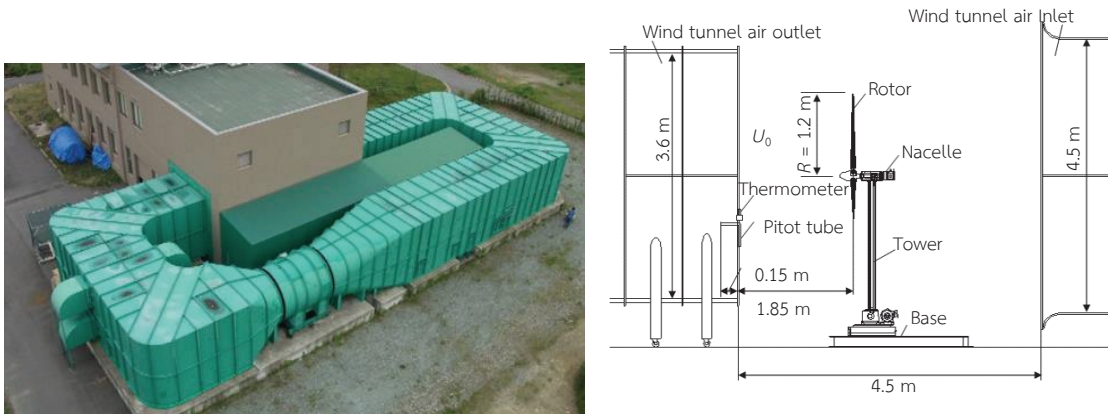
ภาพที่ 2 แสดงภายนอกและภายในอุโมงค์ลม
