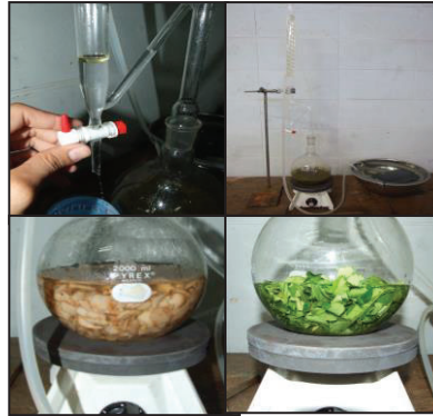
ภาพที่ 3 การสกัดน้ำมันหอมระเหยด้วยวิธีการกลั่นไอน้ำ
