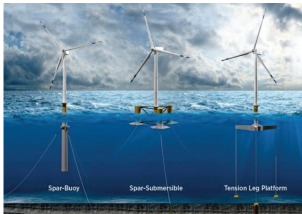
ภาพที่ 4 แนวความคิดพื้นฐานของกังหันลมลอยน้ำ [11]
